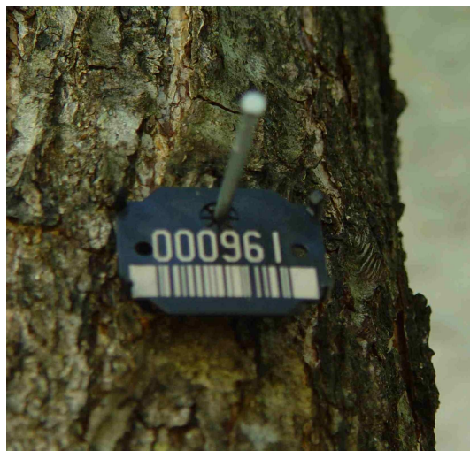
Obr. 2: Systém Arbo-Tag instalovaný na kmeni stromu.
